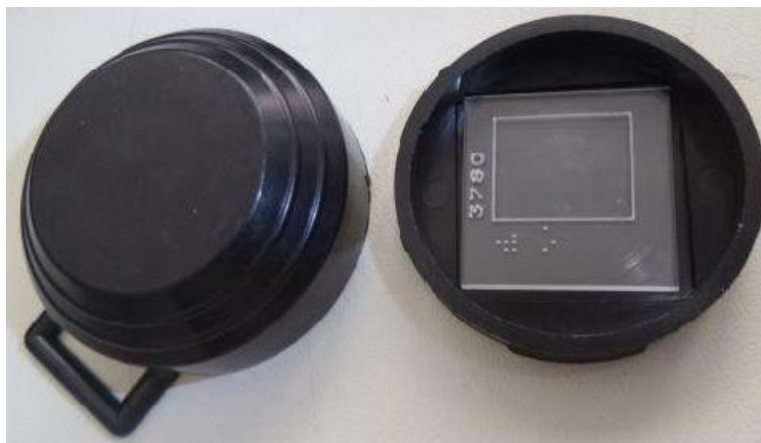
Figura 2: dosimetro di misurazione dell'attività radon indoor
